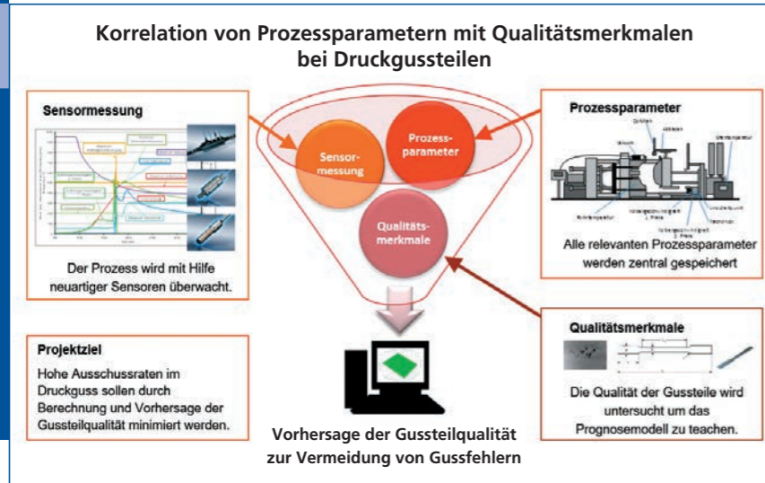
Abb. 3: Prozessschritte bei der Erstellung eines Prognosemodells zu Vorhersage der Gussteilqualität.
