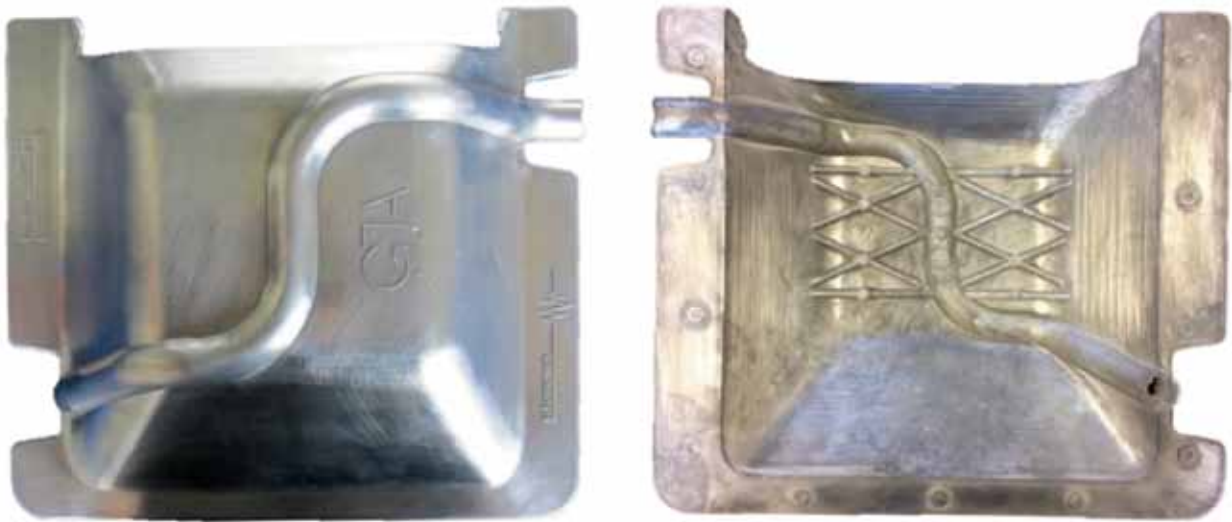
Durch Gasinjektionstechnik hergestelltes Demonstratorbauteil aus Magnesiumdruckguss mit Hohlkanal zur Erhöhung der Steifigkeit.
