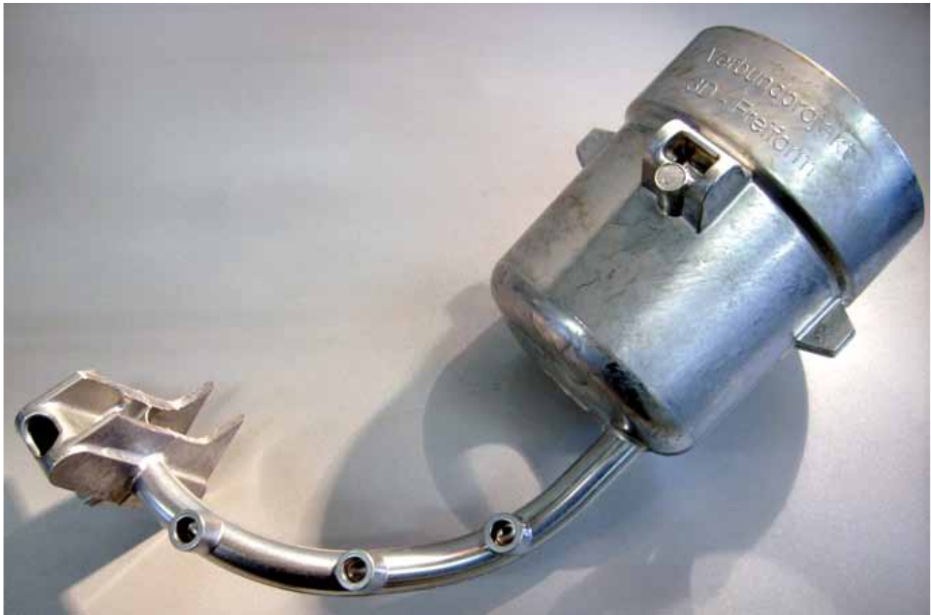
Druckguss-Demonstrator mit dreidimensionalem Hohlraum zur Medienleitung, hergestellt in der Verfahrensvariante der Gasinjektionstechnik.
