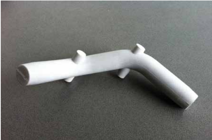
Bild 6: Auf einer Druckgießmaschine aus der schmelzflüssigen Phase hergestellter Salzkern.
