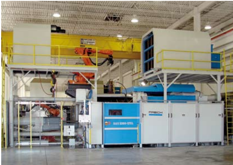
Bild 5: Moderne Gießzelle DAK 2300-275 L der Fa. Frech
