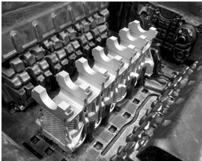
Bild 3: Magnesium-Aluminium-Verbundkurbelgehäuse mit in das Druckgießwerkzeug eingelegtem Aluminium-Insert
