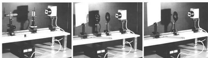
Abbildung 2: Versuchsaufbauten auf der optischen Bank für Versuch 1 (Planplatte, links), Versuch 2 und 3 (Brennweitenbestimmung, Mitte – hier mit Hilfslinsen zur Erzeugung virtueller Objekte oder zur reellen Abbildung virtueller Zwischenbilder) und Versuch 4 (Besselverfahren, rechts)
