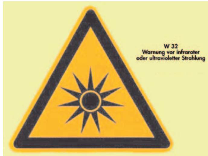
Abb. 4: Warnsymbol W 32 „Warnung vor infraroter oder ultravioletter Strahlung“
