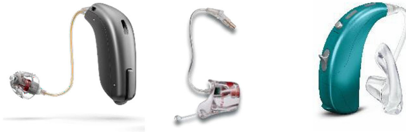
Abb. 3 ▲ Hinter-dem-Ohr-Hörsysteme. Von links nach rechts: sog. Receiver-in-the-Ear (RITE)- oder Receiver-in-the-Canal (RIC)-System mit Schirmchen, Hörer mit individueller Otoplastik, Hinter-dem-Ohr (HdO)-System mit Otoplastik (© Audia-Akustik und Welttag des Hörens)
