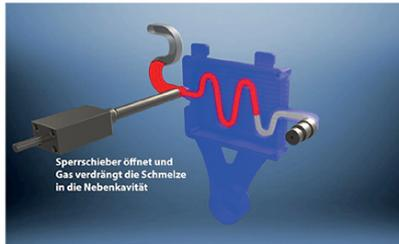
5. Flüssiger Kern wird in die Nebenkavität ausgeräumt
