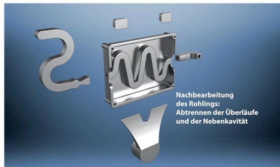
7. Gussteil mit integriertem Kühlkanal
