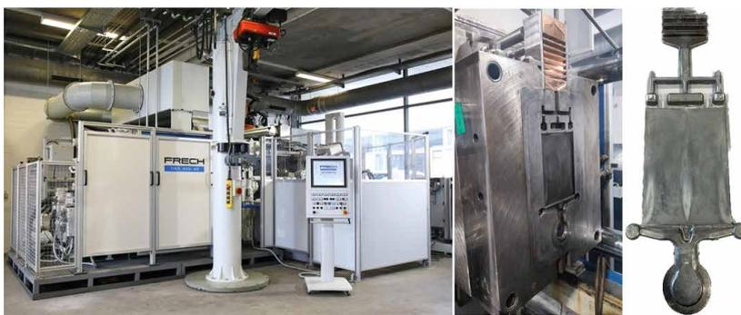
Bild 1: Kaltkammerdruckgussmaschine (Frech DAK 400)/Bewegliche Formhälfte/Druckgussplatte.
