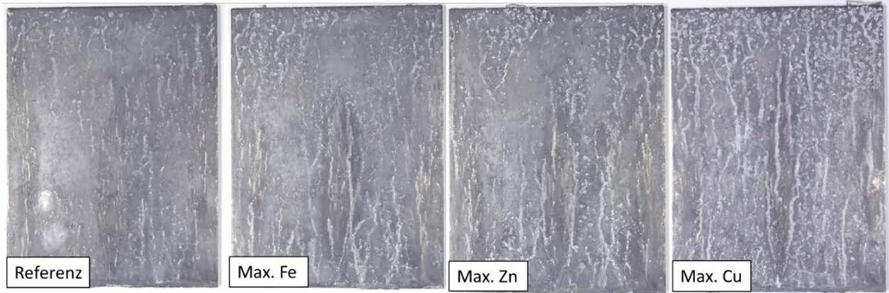
Bild 13: Gussplatten nach 24-stündigem Salzsprühnebeltest [15].
