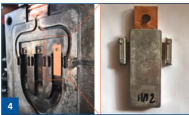
**Abb. 4:** Fixierung der Holzeinleger im Druckgießwerkzeug (links); Hybrides Magnesium-Holz-Gussbauteil (rechts)
