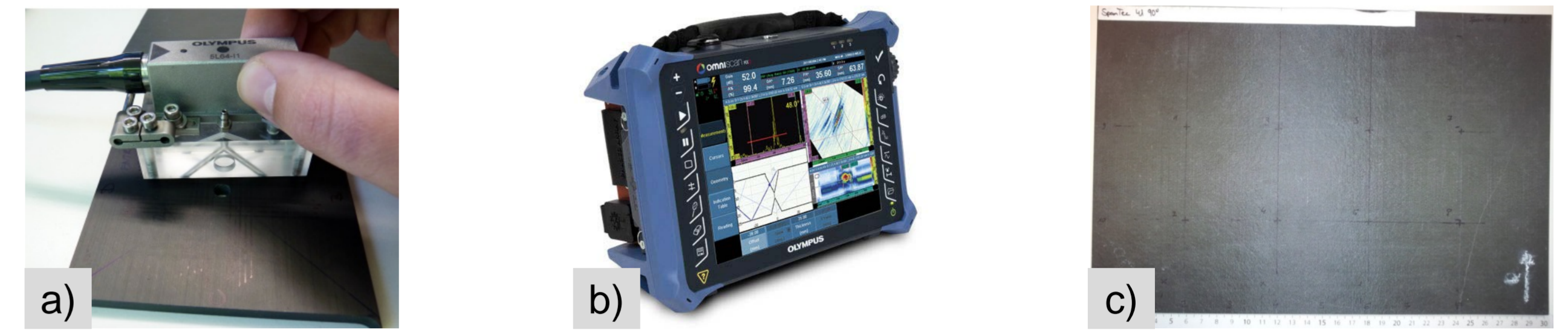
Abb. 2: Für die Untersuchungen verwendete Geräte und Proben. a) Prüfkopf 5L64; b) Phased Array Prüfgerät OmniScan MX 2 ; c) CFK-Probe
