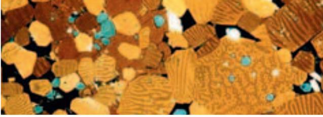
Bild 1: Unterm Lichtmikroskop: Gefügestruktur und Domänenstruktur eines Nd-Fe-B Sintermagneten im Längsschnitt mit polarisiertem Licht.
