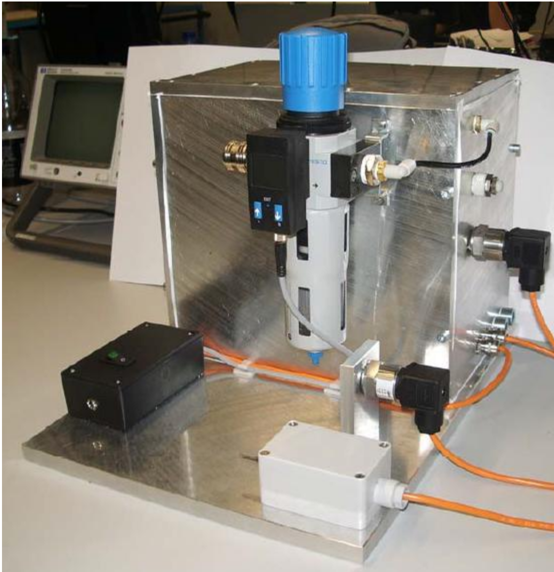
Der Prüfstand mit den applizierten Sensoren
