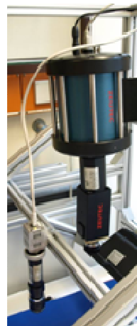
Abb. 1.3.4: Konzept der online Analyse auf Basis Pushbroom Imaging Technologie (links: Gesamtaufbau, rechts: Nahaufnahme des gekühlten NIR Spektrographen mit kleinem VIS Spektrographen).
