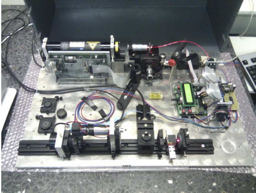
Abb. 1.2.4: Aufbau mit den servogesteuerten Faser-Polarisationscontrollern und der Polarisationsbestimmung über ein drehbares Viertelwellenplättchen, Glan -Thompson-Prisma und Detektor.
