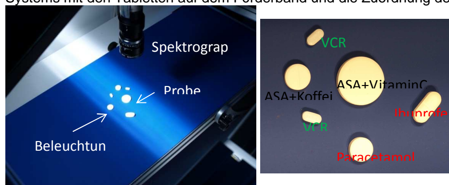
Abb. 1.3.3. Anwendung des online Pushbroom Imagings an partikulären Systemen, hier: unterschiedliche Tabletten. links: Messanordnung, rechts: Zuordnung der Tabletten.
