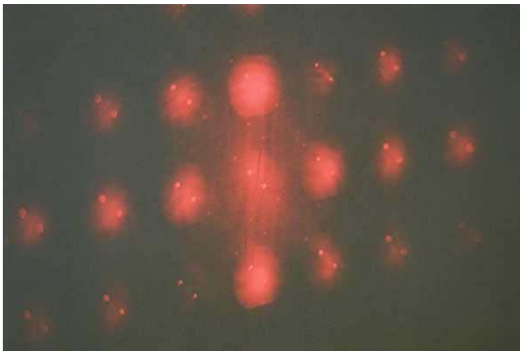
Abb. 1.2.2. Beugungsbild mit jeweils 2 Laser-Foki auf einem 1 m entfernten Schirm.
