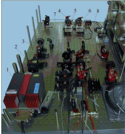
Abb. 2.1.2. Neuentwickelter hochauflösender Laserinterferometer-Setup. Links: Lasersystem mit Nd:YAG-Laser und AOMs, rechts: Interferometer-Optomechanik im Vakuum. Der Aufbau ist symmetrisch in seinen optischen Pfaden.
