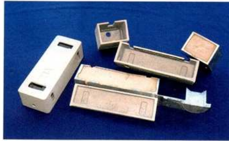
Bild 1: Druckgussteile, die mit Sandkernen auf einer Druckgießmaschine bei druckgießspezifischen Prozessparametern hergestellt wurden.
