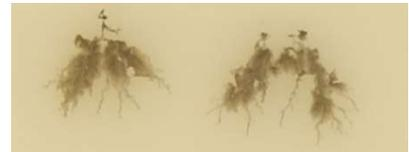
Spuren von Gleitentladungen auf einer AlN Keramik bei max. 8 kV mit  $70 \text{ kV}/\mu\text{s}$ .
