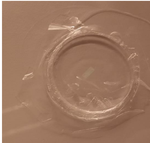
Abbildung 4.28: Wiederholung des Versuchs eine PDMS-Folie auf eine PDMS-Form aufzubringen nach den bereits zufriedenstellenden Bedingungen. Faltenbildung durch das Abziehen der Folie, um die Aushärtung des PDMS zu überprüfen.
