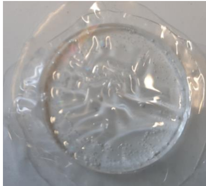
Abbildung 4.24: PDMS-Form mit PDMS-Folie, aufgebracht indem Seife auf den Linsenrohling aufgebracht wird, darauf die Folie und der Metallring und dann die PDMS-Form und wird für 70 Minuten bei 80 °C ausgehärtet. Die Folie hat Falten geworfen.
