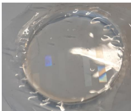
Abbildung 4.25: PDMS-Form mit PDMS-Folie, aufgebracht indem Seife auf den Linsenrohling aufgebracht wird, darauf die Folie und der Metallring und dann die PDMS-Form und wird für 48 Stunden bei Raumtemperatur ausgehärtet. Die Folie hat sich gut an die Form angepasst, bis auf vereinzelte Falten am Rand.
