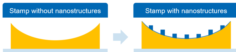
Abbildung 1.4: PDMS-Form auf einem Wafer, auf dem eine Folie mit Nanostrukturen aus UV-PDMS aufgebracht werden soll.
