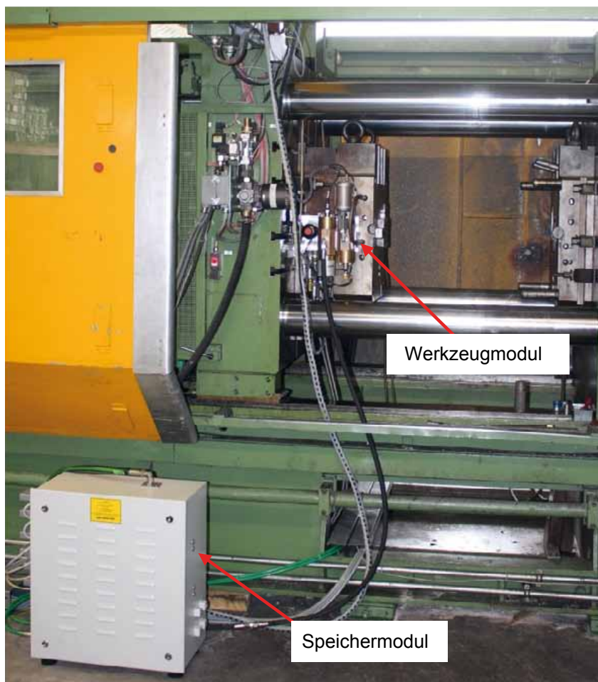
Bild 3: Realer Aufbau des neuen Gasinjektionssystems mit Verdichtermodul, Speichermodul und Werkzeugmodul an einer Kältekammerdruckgießmaschine..
