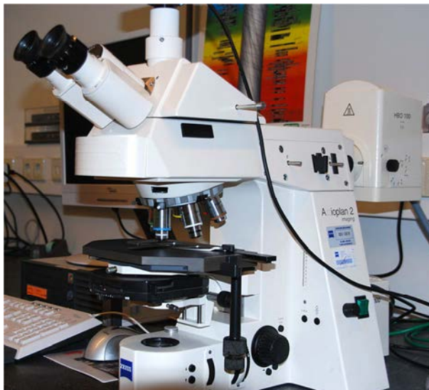
Bild 16: Auflichtmikroskop AxioPlan 2 Imaging der Firma Zeiss
