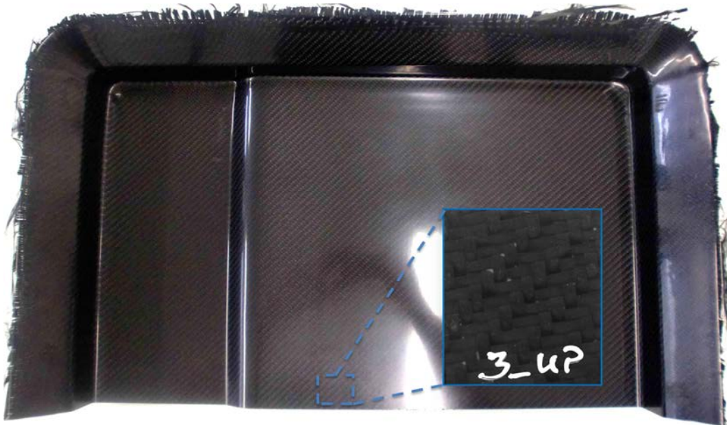
Bild 2: Untersuchten CFK-Proben mit zwei unterschiedlichen Gewebelagen. Wandstärke blieb im Laufe der Untersuchungen konstant.
